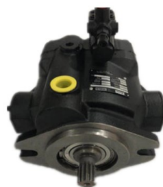
Bomba de Posicionamiento
